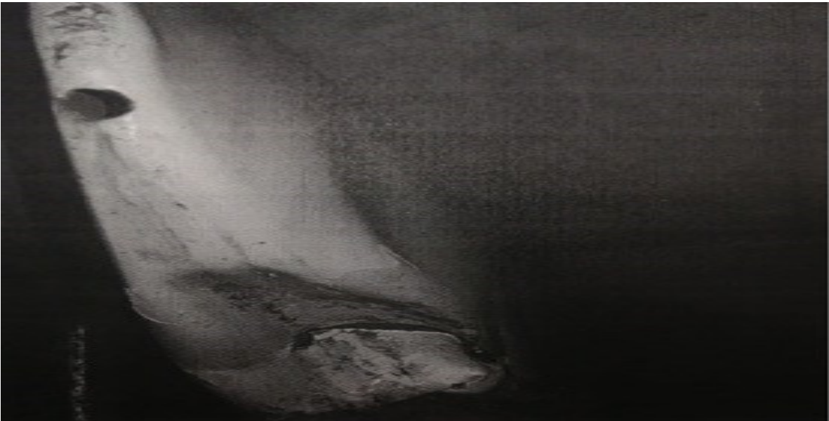
Fotografía No. 9: Ruptura del fairing de salida del flap medio interior, flap derecho.
